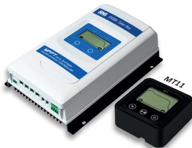
MPPT Solar-Regler (Maximum-Power-Point-Tracking) werden als Bindeglied zwischen den Solar-Panelen und den Batterien benötigt. Bei der MPP-Technologie ermittelt der Regler immerzu automatisch die maximale Leistungsausbeute der Solar-Module. Hierdurch wird die Ladezeit der Batterie im Vergleich zu konventionellen Solarladegeräten deutlich verkürzt. Die MPPT Solar-Regler arbeiten vollautomatisch, mit einem Ladestrom von bis zu 30A bzw. 40A und sind wartungsfrei.
